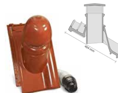
komplet pro odvětrání kanalizace: prostupová taška, nástavec, flexi hadice - díky rotační trubce se dokonale přizpůsobí sklonu střechy - optimální sklon střechy 20° až 45° - hmotnost tašky: 4,1 kg; cca. 4,3 kg - hmotnost hadice cca: 3,0 kg - celková hmotnost 1 ks cca: 7,3 kg - vnitřní průměr otvoru Ø: ca. 100 mm
