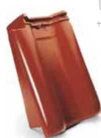
taška okrajová levá - krycí délka cca: 38,3–40,3 cm - krycí šířka cca: 33,9 cm - hmotnost 1 ks cca: 6,4 kg - spotřeba cca 2,5–2,6 ks/ bm
