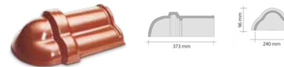
ukončovací hřebenáč nárožní „kapka“ hmotnost 1 ks cca: 3,4 kg
