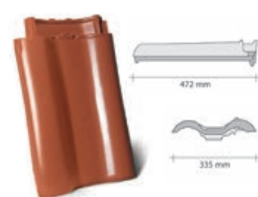
taška s dvojtou návalkou - krycí délka cca: 36,5–40,3 cm - krycí šířka cca: 33,5 cm - hmotnost 1 ks cca: 4,7 kg - používá se jako estetické zakončení levého okraje plochy střechy, namísto základních tašek u kterých by byl vidět zámek. Např. v místě kde střešní plocha navazuje na vyšší stěnu štitu vedlejšího domu.
