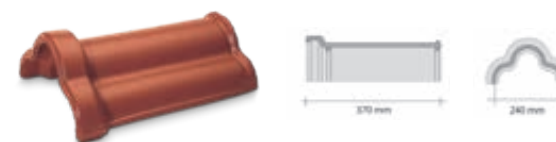
hřebenáč drážkový s příchytkou - potřeba na 1 bm cca: 3,0 ks/bm - hmotnost 1 ks cca: 3,6 kg/ks - krycí šířka cca: 20,5 cm
