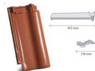
taška poloviční - hmotnost 1 ks cca: 2,5 kg - střední krycí šířka cca: 12,5 cm Poloviční taška není vhodná do úžlabí! Taška v zámku nenavazuje na základní tašku! Zámek má jiný tvar. Používá se jen jako jedna řada tašek od okapu do hřebene, pro dosažení rozšíření krycí šíře střešní krytiny o krycí šířku poloviční tašky, což je cca 125 mm.
